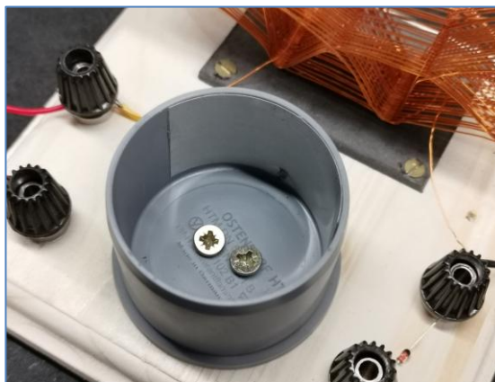
Statorová část kondenzátoru je přichycena dvěma vruty k podkladové desce. V horní části je vidět deska kondenzátoru. Vodič je vyveden vyvrtaným otvorem, který je překrytý deskou.
