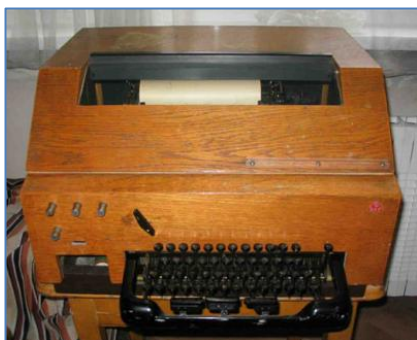
Dálnopisný stroj T51, vyráběný v NDR od 50. let minulého století. Konstrukčně vycházel z dálnopisu Siemens vzor 37. U nás se používal až do konce 70. let.
