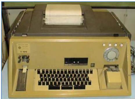
Dálnopisný stroj T100, vyráběný ve Zbrojovce Brno v licenci Siemens od roku 1974. Originál Siemens T100, vyráběný v Německu, byl uvnitř stejný, ale v jiné skříni. Tento stroj používal dvojbarevnou pásku, jinou barvou tiskl přijatý text, jinou vyslaný.
