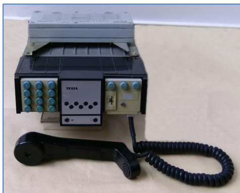
AMR. Šedá zadní část je vlastní radiostanice, na ní shora diplexer (anténní sdružovač). Černá část je ovládací skříňka, kterou bylo možné oddělit a propojit se stanicí kabelem.
