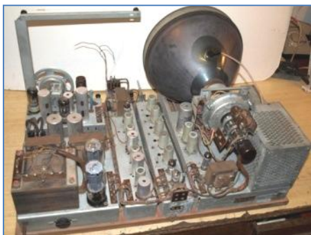
▲ TESLA 4002, pohled dovnitř. Vlevo nahoře rozhlasový díl.
