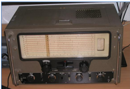
▲ Komunikační přijímač TESLA Lambda 5, 300 kHz - 30 MHz. Na nižších rozsazích pracuje jako superhet s jedním směšováním, na vyšších rozsazích s dvojným.
