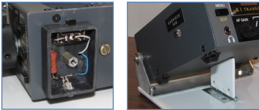
▲ Přidal jsem lampičku a otočný závěs s podpěrou.
