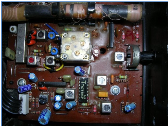
Původní deska s TA7640AP (AM/FM zesilovač a detektor)
