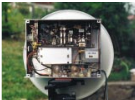
Zařízení OK1UFL pro 76 GHz.
