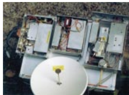
Zařízení OK1UFL pro 24, 47 a 76 GHz.
