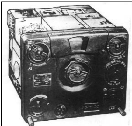
OBR. 11: Přijímač letu na cíl EZ6 - první provedení. Vlevo nahoře je přepínač druhu provozu a nastavení šíře pásma, stupnice a „vyjasňovač“ /C155/. Uprostřed tandemový knoflík hrubého a jemného ladění stupnice, vedle je spínač rozsahů. V dolní části je nastavení hlasitosti, kulatá zásuvka sluchátek a přepínač pro vše-směrový, cílový a zaměřovací provoz. Obdélní-ková zásuvka je pro připojení kontrolního měřícího přístroje.
