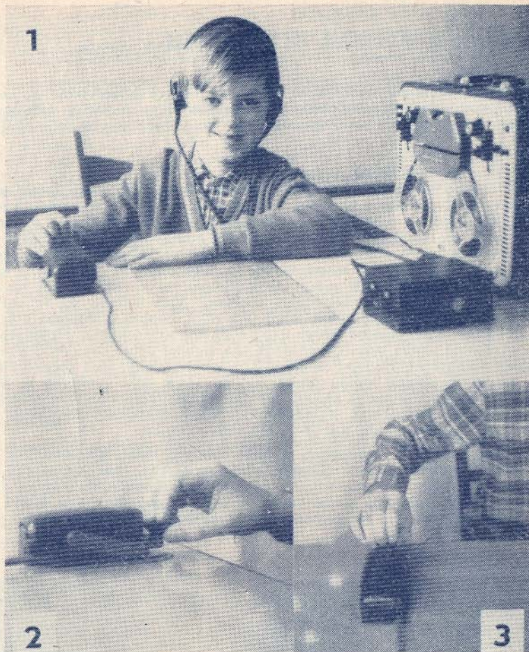
1 – Asi v takovém dětském věku získávají začátečníci rozhodující návyky. Každé vysílání je nutno kontrolovat alespoň magnetofonem. Chlapec na snímku sedí příliš nízko – stůl je pro něj příliš vysoký. 2 – Tlačítko klíče je několik centimetrů od hrany stolu, ruka se ničeho jiného nedotýká. 3 – Ruka musí být přímo v ose klíče.
