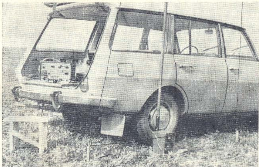
Obr. 7. Pohled na celé pracoviště s umístěním anténního členu a uchycením přívodu ke kolíku.
