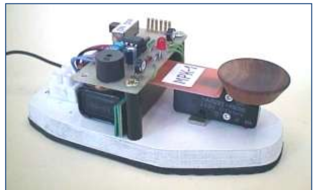
▲ Víceúčelový klíč, umožňuje základní test obvodů a součástek
