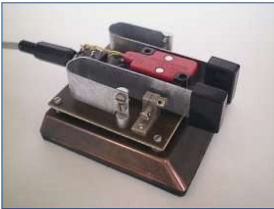
◀ Pasticčka s mikrospínači a planžetami
