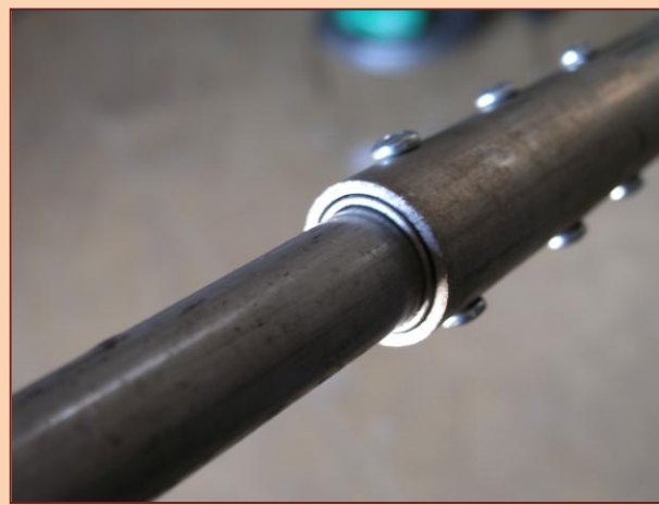
Obrázek 8 - Způsob tubingů trubek 22, 16 mm
