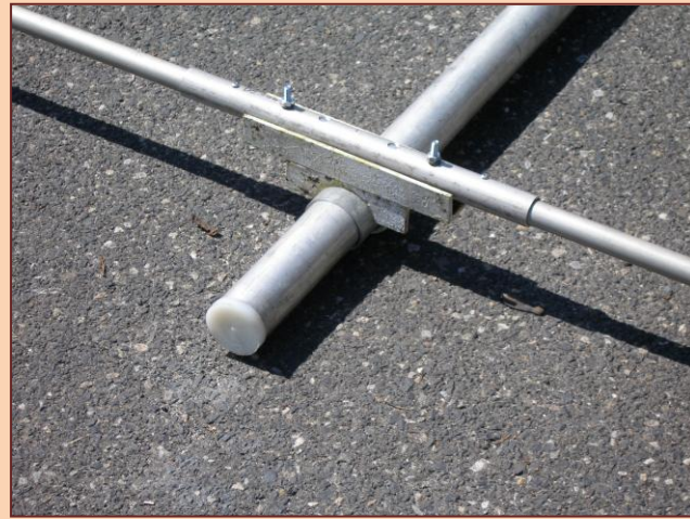
Obrázek 4 - Způsob uchycení prvků k ráhnu
