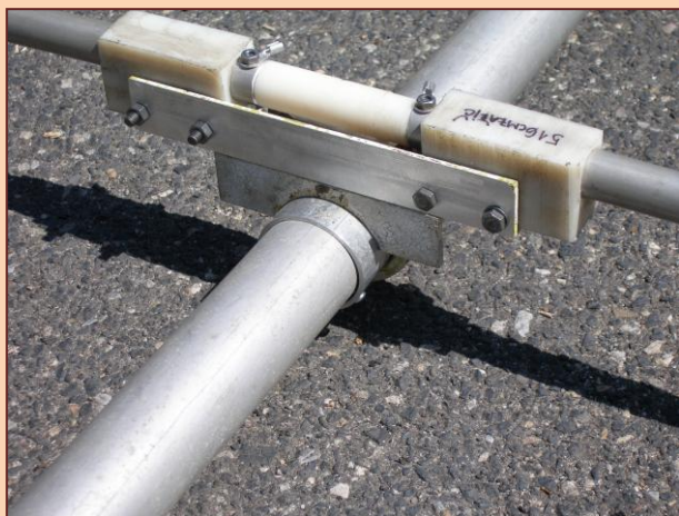
Obrázek 7 - Uchycení zářiče k ráhnu
