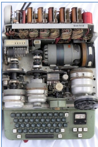
◀ Původní československá konstrukce páskového dálkopisu D302 Dalibor, výroba Zbrojovka Brno. Na rozdíl od tehdy obvyklých mechanických dálkopisů vykonávala většinu funkcí elektromagnetická relé.
