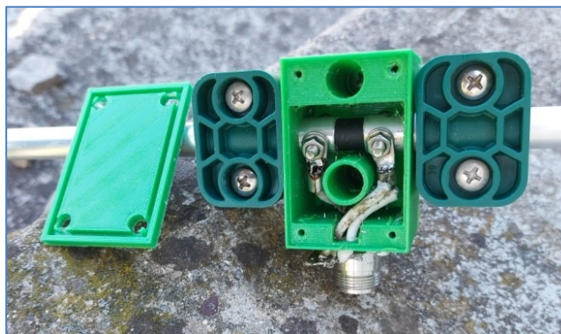
Prototyp středu dipólu z 3D tiskárny
