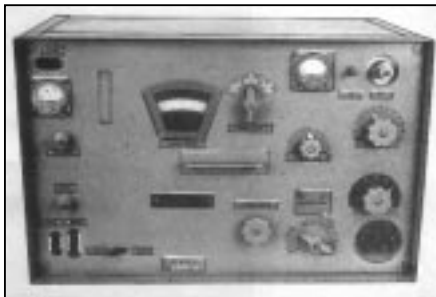
Ovládací panel vysílače 80W.S.a. Ovládací prvky jsou stejné s vysílačem 30W.S.a, až na přepínač výkonu 80W/10W vlevo dole.
