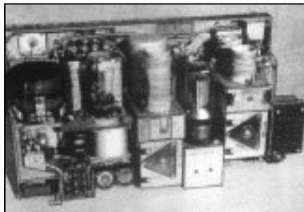
Vysílač 30W.S.a, kryty sejmuty.
