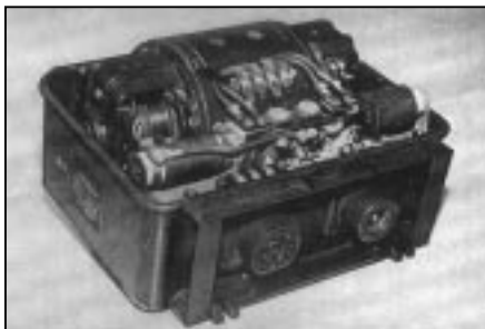
Rotací jednotkový měnič U80a pro vysílač 80W.S.a. Z baterie odebírá proud 35A, má hmotnost 29kg a při 2600ot/min dodává výstupní napětí +800V/0,3A a -300V/30mA. Měnič je uložen v těsném pouzdru. Vlevo je osminásobná zásuvka konektoru, vpravo přívod vozidlové baterie.
