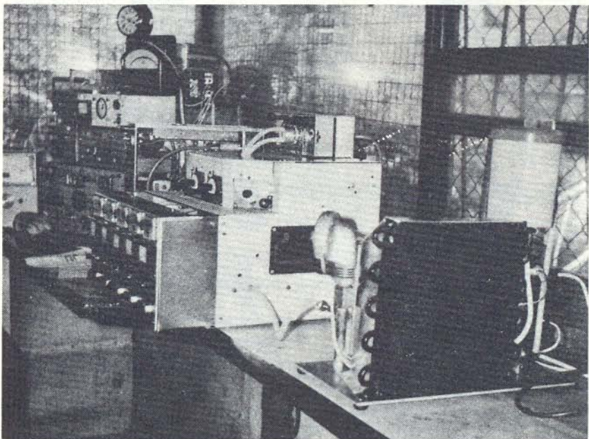
Koncový stupeň vysílače v popředí olejové chlazení
