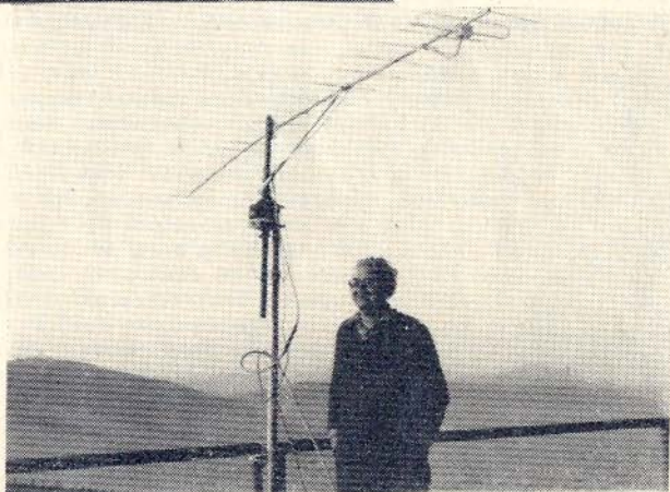
23prvková anténa loop Yagi podle G3JVL pro 1296 MHz fotografovaná v době, kdy byl vrcholek Klínovce nad teplotní inverzí.
