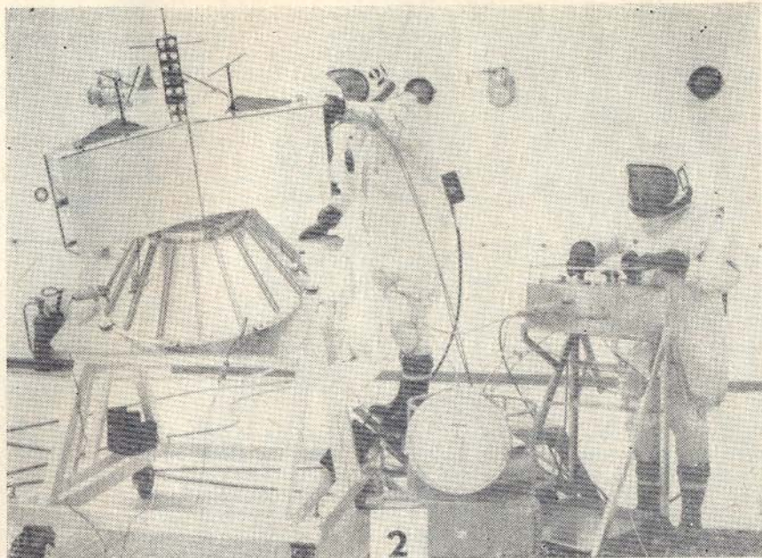
1 (...) – náčrt celé rakety a detail přístrojového pouzdra s družicemi ECS-1 a Phase IIIB; 2 – plnění přidavného raketového motoru se musí odehrávat v ochranných skafandrech a při zakrytých slunečních štítcích; 3 – spouštění družice do ochranného pouzdra; 4 – kompletační skupina pracovníků AMSAT a AMSAT-DL, zcela vpravo dole je duchovní otec palubní elektroniky dr. Karl Meinzer DJ4ZC, na všech snímcích jsou dobře patrné anténní systémy.
